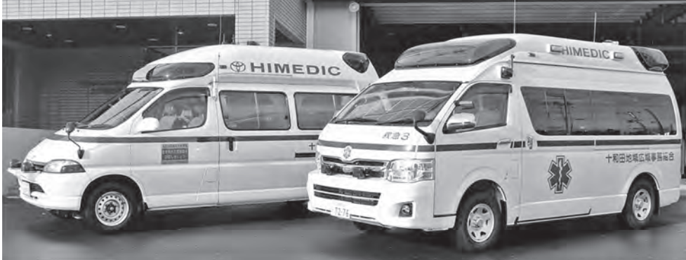
[写真右] 全長5.62m 全幅1.89m 全高2.55m 車両総重量 3,235kg 定員7名
