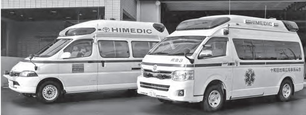
[写真右] 全長5.62m 全幅1.89m 全高2.55m 車両総重量 3,235kg 定員7名
