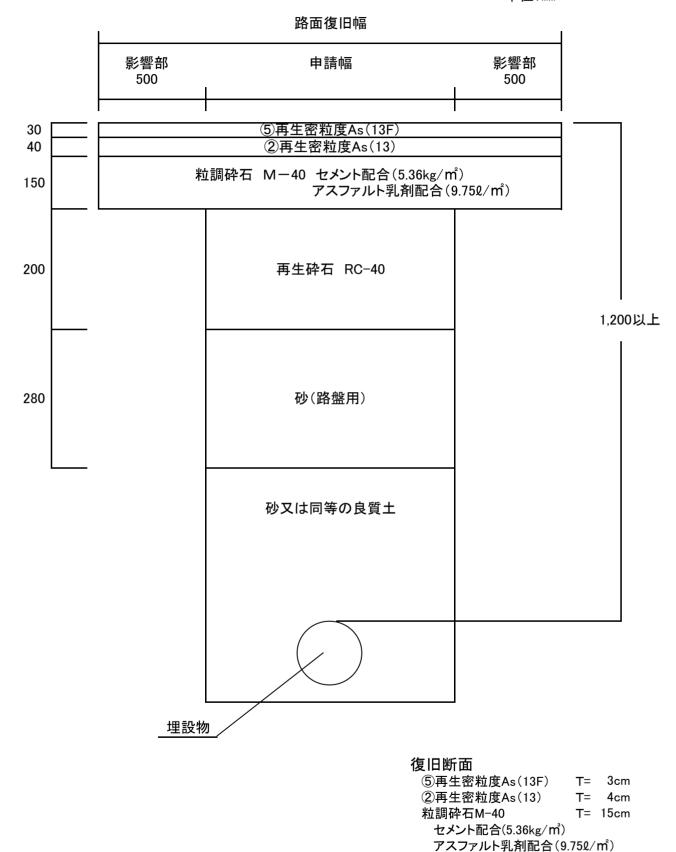
※影響部の端から舗装端又は異種舗装までの距離が0.5m以下のときは、その部分を 影響部として表層を打換えることとする。
