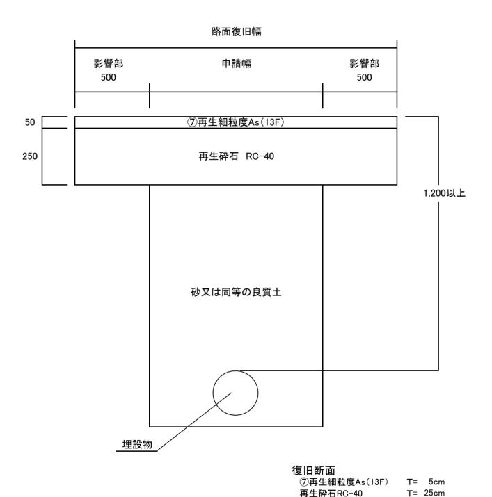
※影響部の端から舗装端又は異種舗装までの距離が0.5m以下のときは、その部分を 影響部として表層を打換えることとする。 ※舗装切断面には、常温で粘着性を有する瀝青系の成形目地材を貼りつけること。
